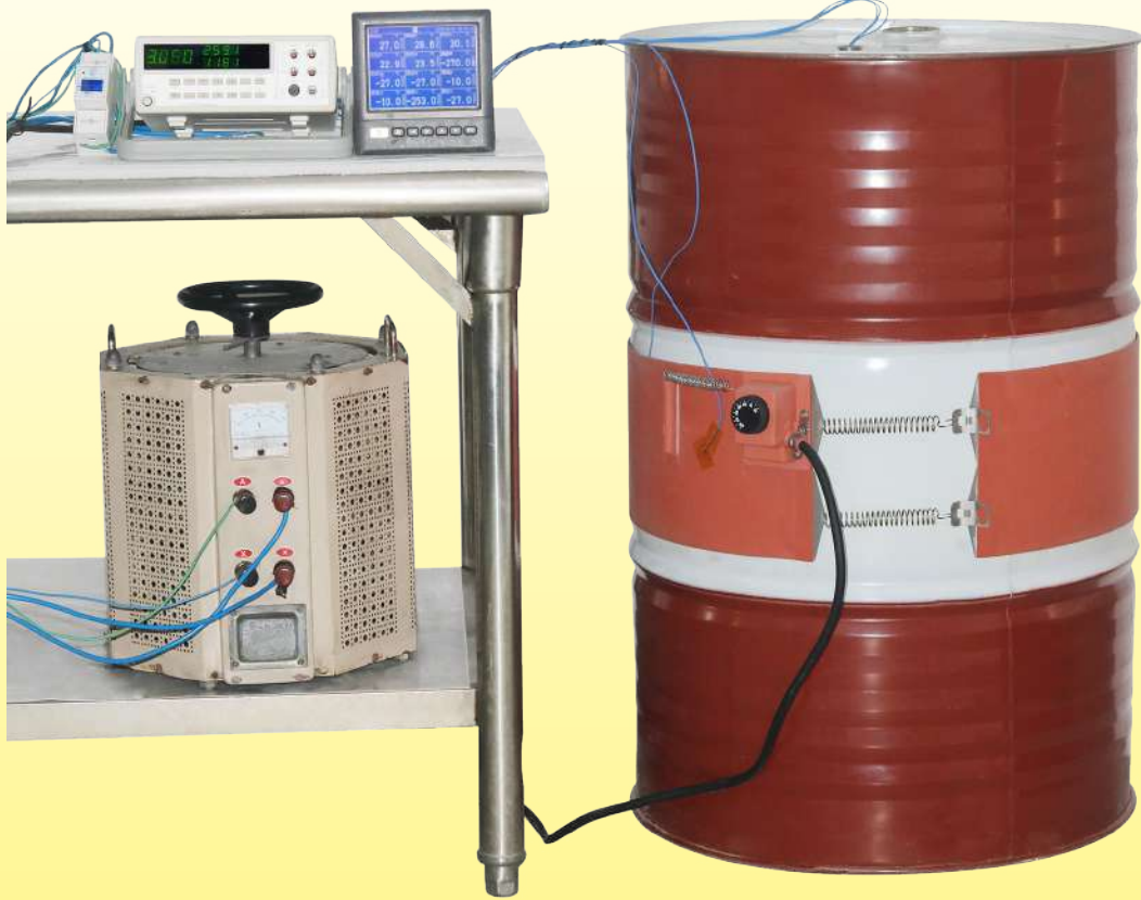
220 升金属鼓形桶的温度随时间的变化，装满水，用一块 200mm 宽的硅胶加热带加热，不带保温层，功率 2250W(表面负荷 0.75W/cm 2 )。
